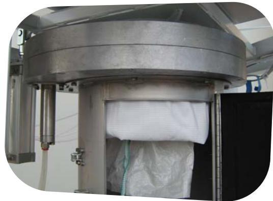
Per garantire la totale tenuta e ovviare alla fuoriuscita di polveri in ambiente, il pianale può essere invece dotato di dispositivo di bloccaggio e tensionamento della manica di scarico del saccone azionato anch'esso da attuatori pneumatici con regolatore di corsa.
