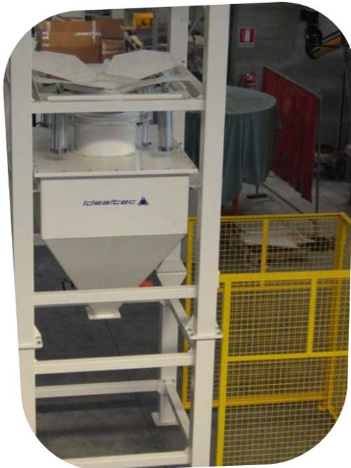
Completano la serie i modelli con cancelletto di protezione, per ovviare alla sosta dell'operatore sotto i carichi sospesi, con scala e ballatoio, per le stazioni che si elevano fino a 11 m di altezza e che accolgono tramogge di carico con capacità di 3000 litri, nonché i modelli corredati di cabina taglia sacchi manuale integrata.
