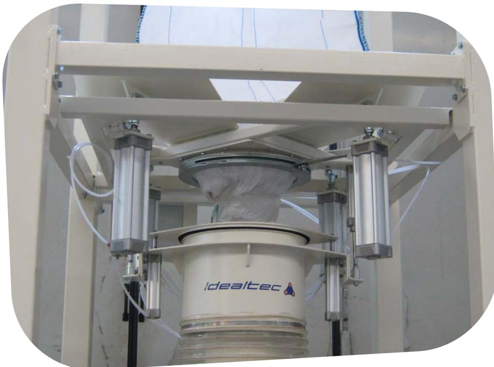
Il materiale può essere scaricato a intervalli regolari e in quantità controllate mediante l'impiego di celle di carico montate a terra, sotto la struttura portante della stazione svuota big bag; mentre l'alimentazione controllata delle unità di trasporto collegate in cascata può essere ottenuta con l'ausilio di convogliatori volumetrici o gravimetrici (convogliatori a coclea) accoppiati allo scarico della stazione svuota FIBC.
